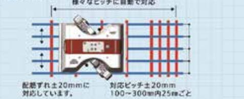
■主筋-配筋高さズレ断面図
