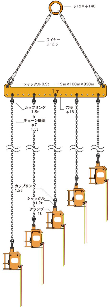
・鉄筋がバースに順次着地するため作業がしやすい。
